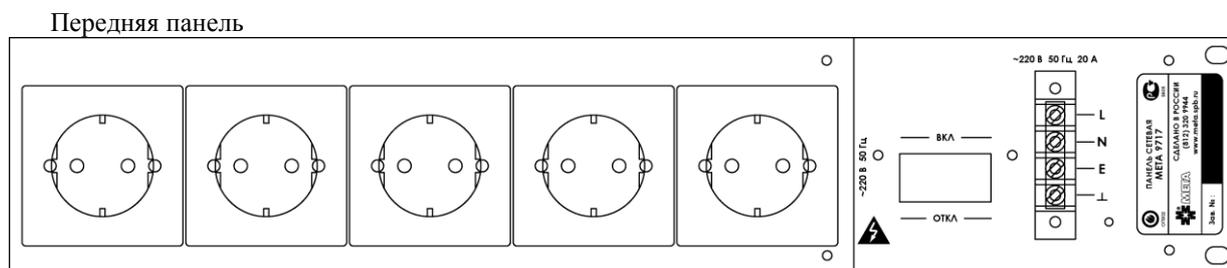
Панель представляет собой пассивное устройство раздачи питания с встроенным автоматическим устройством защиты от токов короткого замыкания и фильтром высокочастотных помех.
